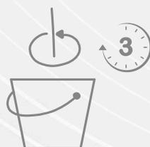
**4-** Puede ser mezclado en hormigoneras comunes, en mezcladoras horizontales a paletas, o con un taladro portátil provisto de batidor de paletas. La temperatura ambiente no deberá ser inferior a los 5 °C ni superior a 30° C.
