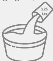
**2-Aconsejamos** agregar inicialmente un 90 % del agua, para posteriormente agregar el polvo, batir alrededor de 1 (un) minuto en flujo constante y agregar el agua restante hasta lograr una mezcla bien fluida homogénea y sin grumos
