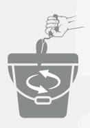
**2-Como membrana cementicia:** Coloque en un balde de 20 L., seis litros y medio (6,5 L) de agua.Posteriormente, agregue los 10 kg de membrana cementicia al agua en forma pausada e ir mezclando de forma mecánica, utilizando taladro y mezclador, verificando que no se formen grumos.
