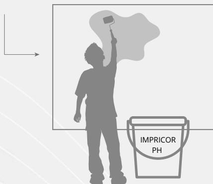
3- Aplicar enduido por la zona afectada, Dejar secar de 4 a 8 horas, según el espesor y la humedad ambiental, y emparejar mediante lijado en seco.
