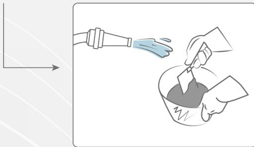
• **4.** Una vez humedecido el sustrato sin charcos ni brillo acuoso, aplique una capa fina del adhesivo con la parte plana de la llana y posteriormente coloque el adhesivo con la parte dentada de la llana correspondiente.
